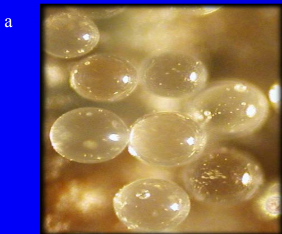
Оптич. Микрофотографии стеклянных бусин без покрытия (а) и после покрытия PtAlCl (б) (увелич. 1/100)
